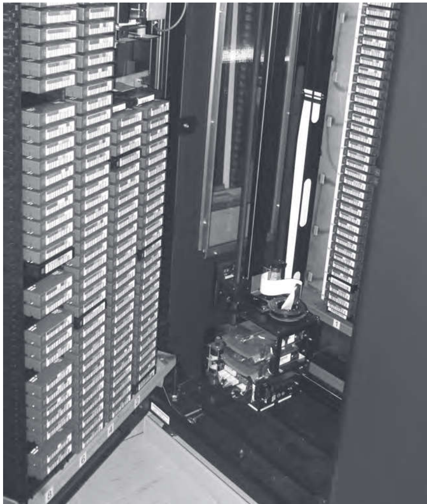
Abb. 1: Blick in die geöffnete Tape-Library des HRZ. Der Robotergreifarm befindet sich in Ruhestellung. Knapp 10 Prozent der Bandkassetten sind sichtbar.
